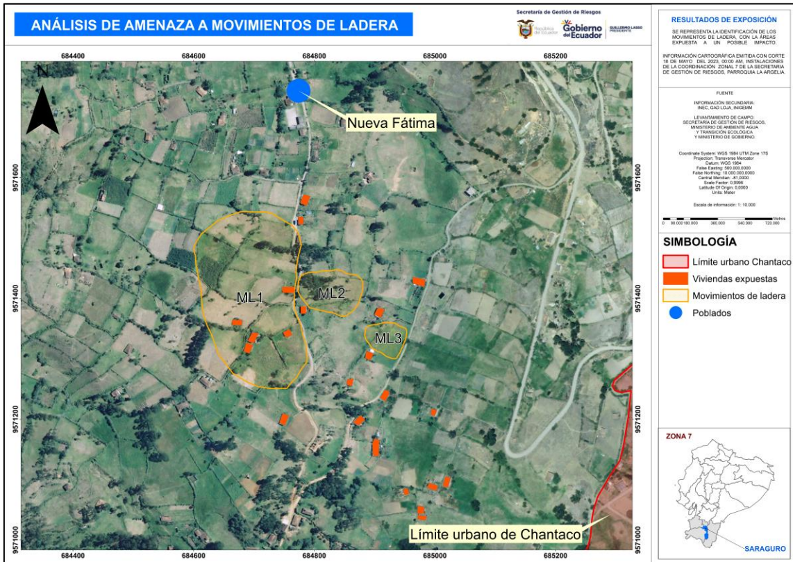
Mapa 8: Viviendas expuestas a afectación en caso de producirse un colapso de la inestabilidad generada. Fuente: Levantamiento de campo.
