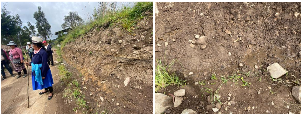
Ilustración 1: Depositaciones coluviales donde se observa directamente la matriz arenosa que sostiene los cantos angulosos de las rocas volcánicas de composición andesítica.
